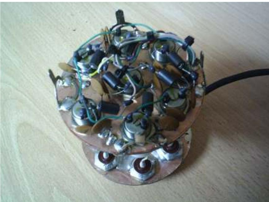
L'unità di "comando" è alimentata tramite rete elettrica (220V) , protetta (internamente) da fusibile ed azionata da interruttore (sul retro).
