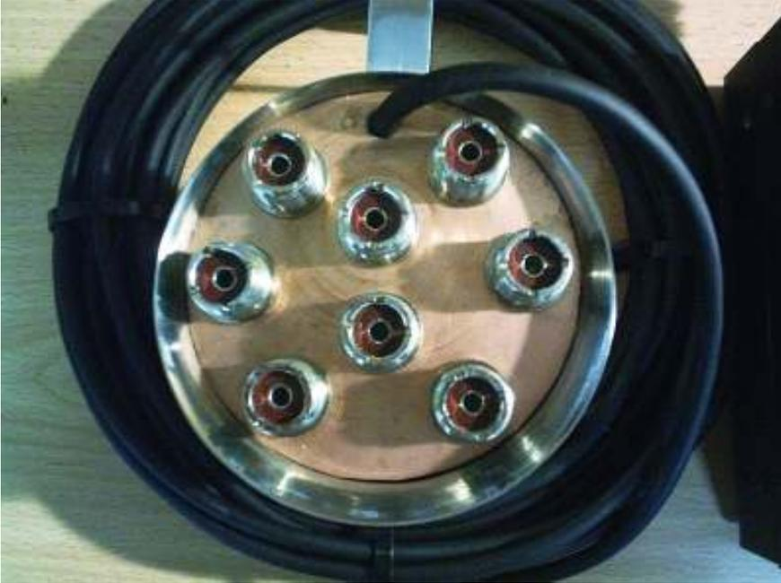
La parte interna ove sono presenti le alimentazioni dei relè risulta ulteriormente schermata sia intrinsecamente (separazione fisica tramite schermatura) che con circuiti “pi-greco” dedicati che evitano qualsiasi problematica di captazione RF.
